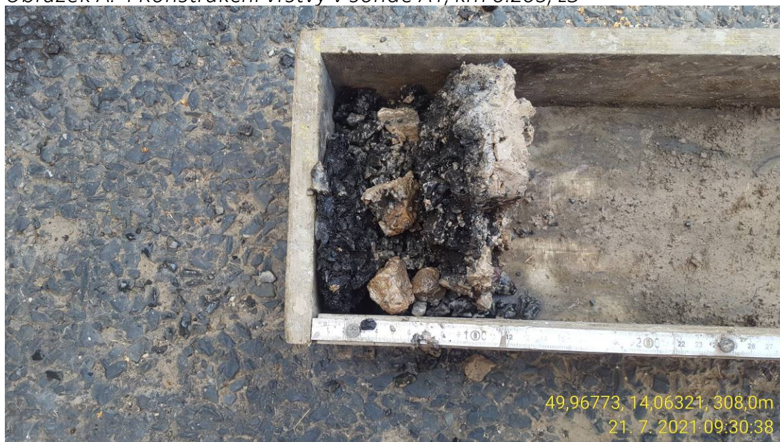
Obrázek A. 4 Konstrukční vrstvy v sondě A1, km 0.205, LS
