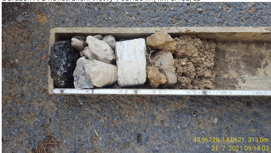
Obrázek A. 2 Konstrukční vrstvy v sondě K1, km 0.100, LS
